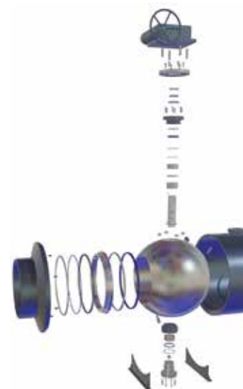
Рисунок 5 – Конструкция шарового крана DN 500, 700
