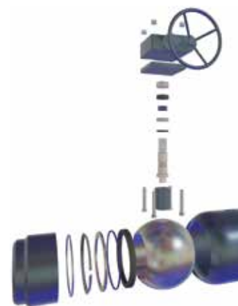
Рисунок 3 – Конструкция шарового крана DN 250
