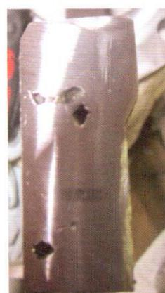
Рис. 5. Несплошности и поры в основном металле
