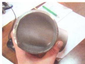
Рис. 1. Расслоение металла, несплошность
