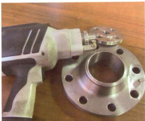
Рис. 3. Проверка химического состава стали
