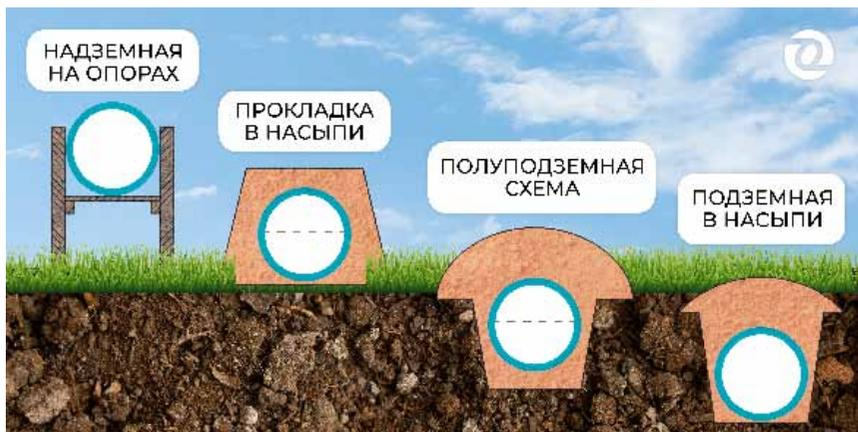
Рис. 1. Схемы прокладки труб
