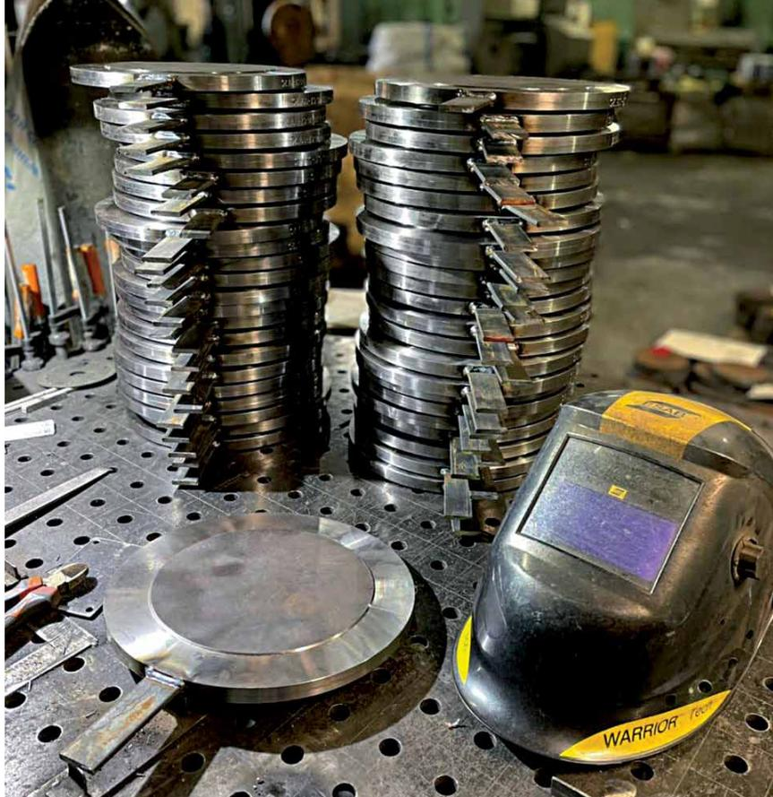
Они также наиболее подходят для применения при высоких температурах. Если сравнить с поворотными заглушками, то можно выделить следующее: фланцевые заглушки применяют с целью надежно и основательно остановить поток внутренней среды, тогда как обтюраторы устанавливают при временном перекрытии потока.
